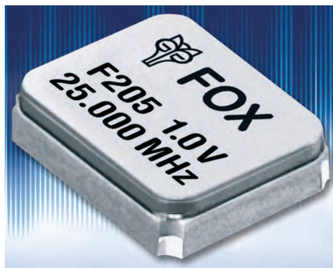
Bild 2: Die »F200«-Serie von Fox Electronics bietet einen Stromverbrauch von maximal 3,5 mA bei Abmessungen von 2,5 mm x 2 mm
