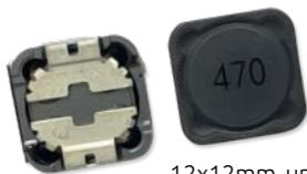
Der taiwanische Hersteller EVEROHMS bietet jetzt eine Reihe von Leistungsinduktivitäten an. Die geschirmte ECDH-Serie gibt es in bekannten Größen von 3x3x2mm über 7.5x7.5x4.5mm bis hin zu 12x12mm und Höhen von 5mm, 6mm, 8mm oder 10mm.
