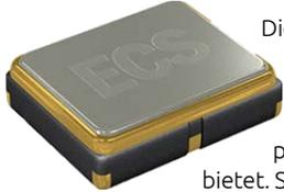
Diese TCXOs zeichnen sich durch eine analoge Kompensation aus, die erweiterte Möglichkeiten der Frequenzkompensation in einem einzigen IC bietet. Sie nutzen eine hohe Aktualisierungsrate bzw. Frequenzkalibrierungslösung, um eine lineare Frequenzabgabe während der Temperaturkompensation aufrechtzuerhalten. Dadurch werden Frequenzsprünge minimiert, wie sie bei der Verwendung herkömmlicher digitaler Kompensation typisch sind.
