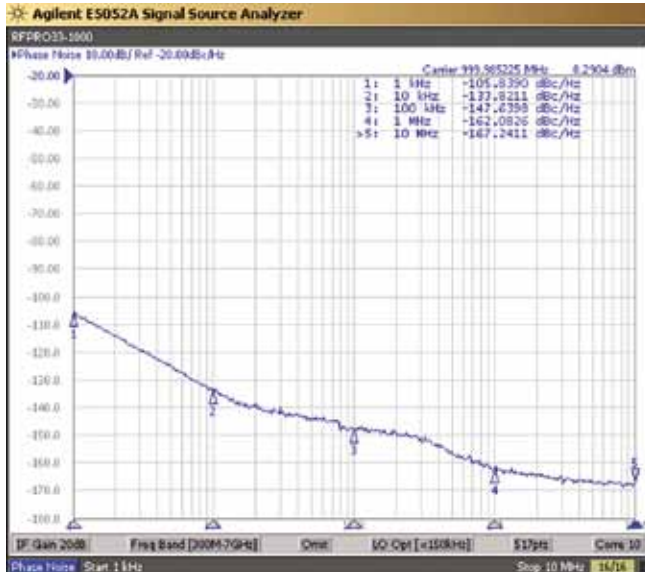
Der RFPRO33-1000: Eine portable 1-GHz-Quelle mit einer Phasenrauschleistung von nur -133 dBc/Hz bei 10 kHz Offset.
