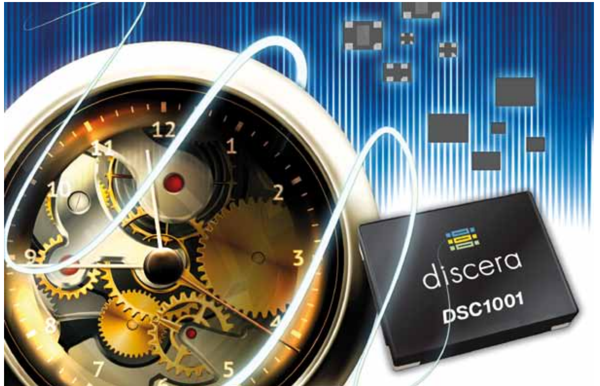
MEMS-Oszillatoren wie Disceras DSC1001 haben im Vergleich mit den dominierenden Quarzschwingern eine hohe Schock- und Vibrationsfestigkeit.
