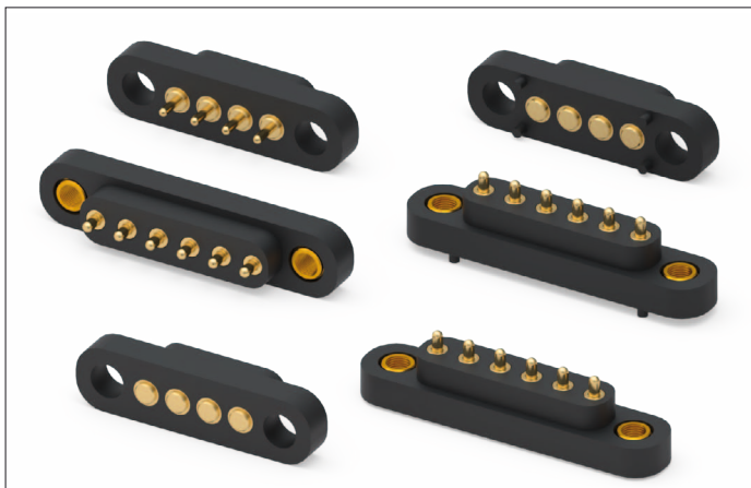
Bild 3: Extra robuste Module mit 9 A Strombelastung und seitlichen Befestigungsoptionen (Durchgangsloch oder Gewinde)
