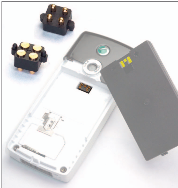
Bild 11: Interne und externe Ladepunkte für Akku und Dockingstationsanbindung bei mobilen Endgeräten zur Daten- und Signalübertragung
