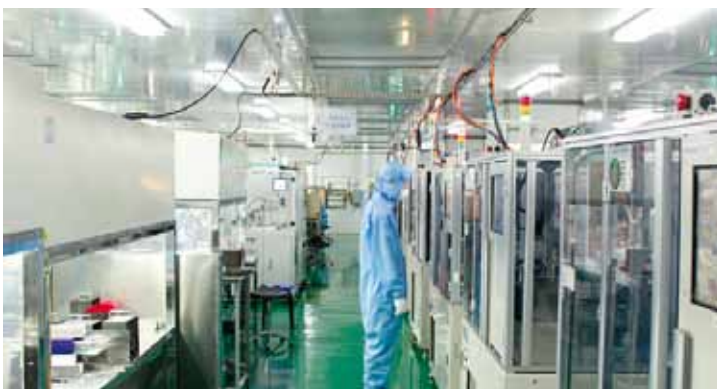
Montage der Quarz-Blanks unter Reinraumbedingungen
