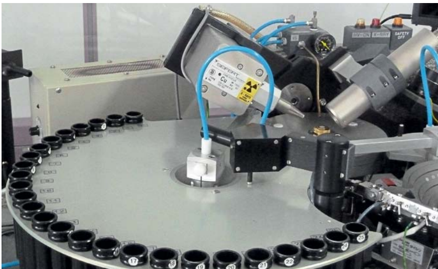
2 | Winkelsortierer: Quarze, die hier aus der Toleranz fallen, werden für Anwendungen mit breiter gefassten Spezifikationen genutzt
