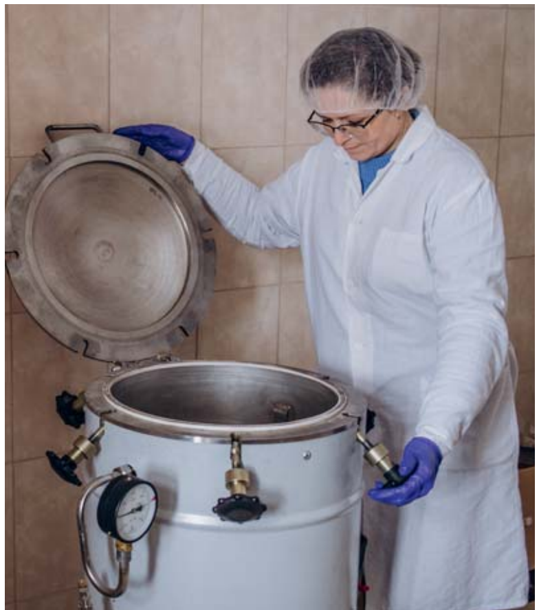
Bild 4: Die Quarzzucht erfolgt aus einer wässrigen Lösung in großen Autoklaven.
